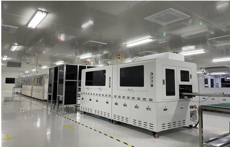
自動ボンディングライン Clean room:class1000
